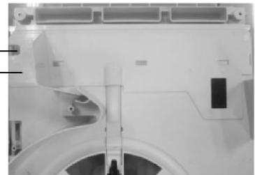
Открутите гайку вентилятора для его демонтажа.
