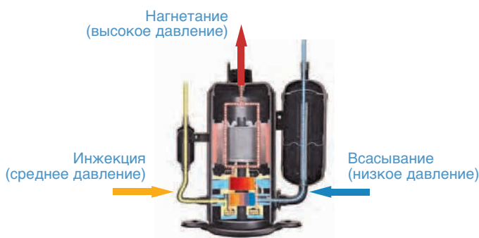
Двухступенчатый DC-инверторный компрессор
