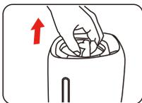
1. Снимите распылитель. Возьмите за ручку бак для воды и снимите из основания.
