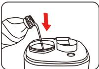
3. Заполните водяной бак холодной водой. Закрутите крышку бака и правильно установите резервуар для воды на основание.
