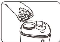
2. Поверните резервуар для воды вверх дном и отвинтите крышку бака.
