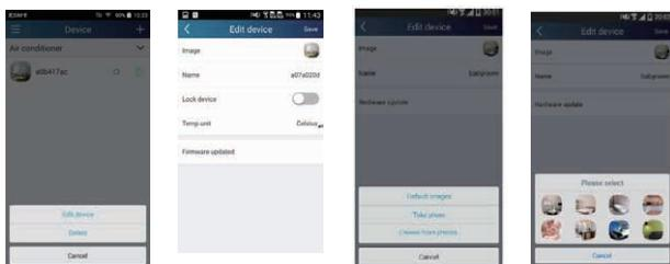
Шаг 2: Для изменения имени устройства нажмите «Name» (Имя) и сохраните его. Перед вами появится имя устройства. Для блокировки устройства включите кнопку «Lock device» (блокировка устройства). После этого другие смартфоны не смогут обнаружить его. Для изменения температуры устройства нажмите «Temp unit» (температура устройства).
